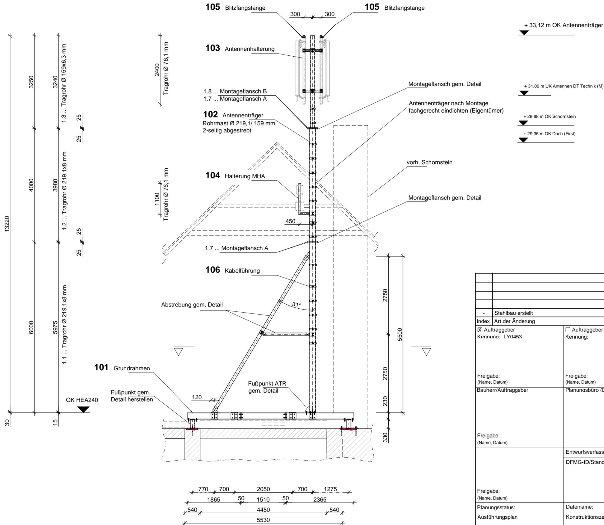
Dargestellte Konstruktion 1x fertig.
